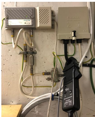
Bild 13 – Anordnung zur Messung vagabundierender Gleichströme auf dem Schirm des Koax-Anschlusses
