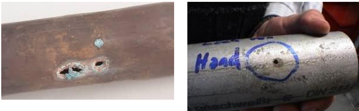
Bild 15 – Streustromkorrosion in Rohren
