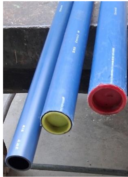
Bild B.1.9 – Wasser-Hausanschlussleitung (heute)
