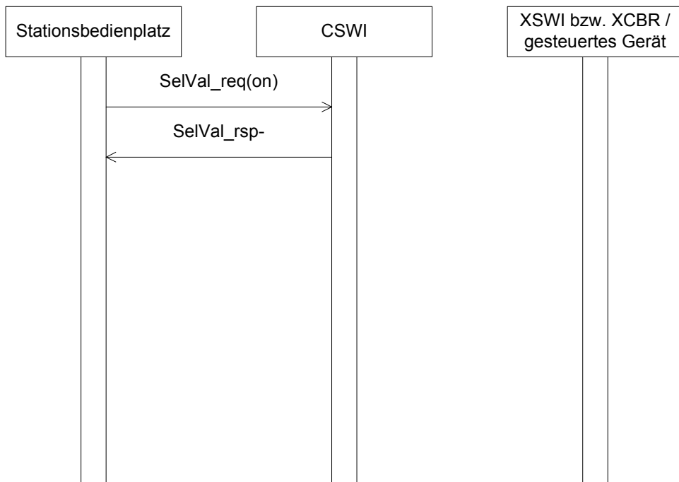
Bild 4: Abbruch der Sequenz nach negativem Testergebnis ("Select"-Phase)
