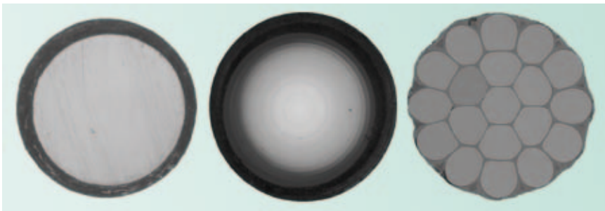
Bild 2. Stufenindex-, Vielstufenindex- und Vielkern-Polymerfasern
