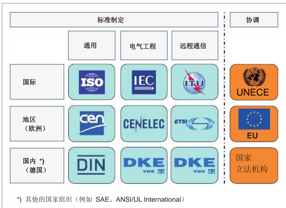
图 2: 标准制定和标准化机构的主要组成及与协调机构之间的关系
